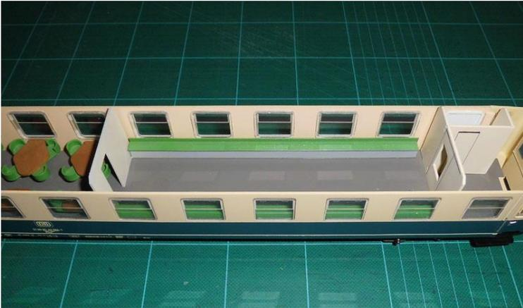
Denn auf die Kühlschranks versichtet ist, sind die ersetzt durch Technische Schranken für das Beschallungsmaterial die aus L Profilen hergestellt sind und silbergrau nachlackiert..
